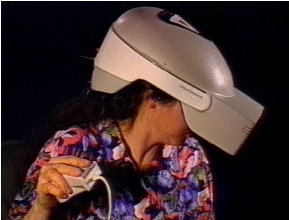
HMD fra Virtual Research: 3000$, opløsning på 479 x 234 pixels. 3D-mus og tracker.
