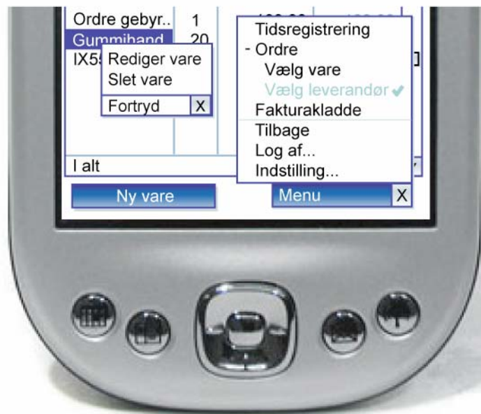
Figur 5.5a – viser, hvordan 5-vejsnavigationsknappen, soft keys, pop-up menuer og objektmenuen indgår i PDA-brugergrænsefladen.
