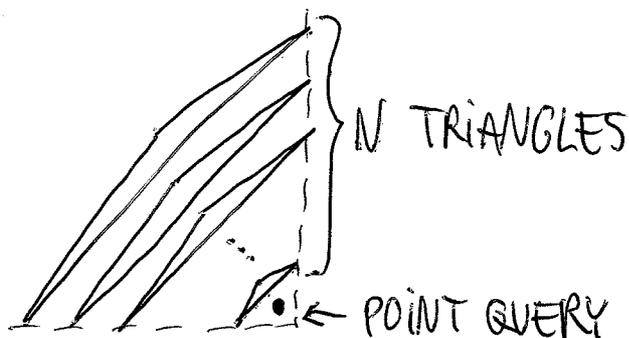
SINCE THE BOUNDING BOX FOR ANY SUBSET OF THE TRIANGLES CONTAINS THE POINT, A SEARCH MUST VISIT ALL NODES IN THE R-TREE TO SEE THAT THE POINT IS IN NO TRIANGLE.
