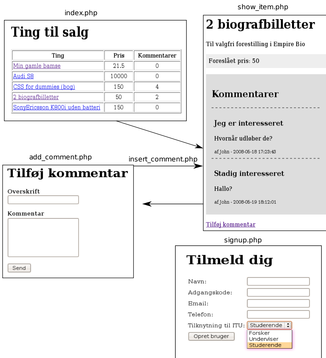
Figur 1: Site-map for det web-baserede system. Et screenshot (kasser) i diagrammet angiver sider, brugeren kan se i systemet. Hver sides navn er angivet ovenfor hvert billede. En ikke-annoteret pil i diagrammet angiver, at en bruger kan klikke på et link i en side for at springe til en anden side. En annoteret pil i diagrammet angiver, at brugeren ved at klikke på en knap forårsager, at php-scriptet annoteret på pilen bliver kørt på serveren, og at php-scriptet videresender brugeren til en ny side.
